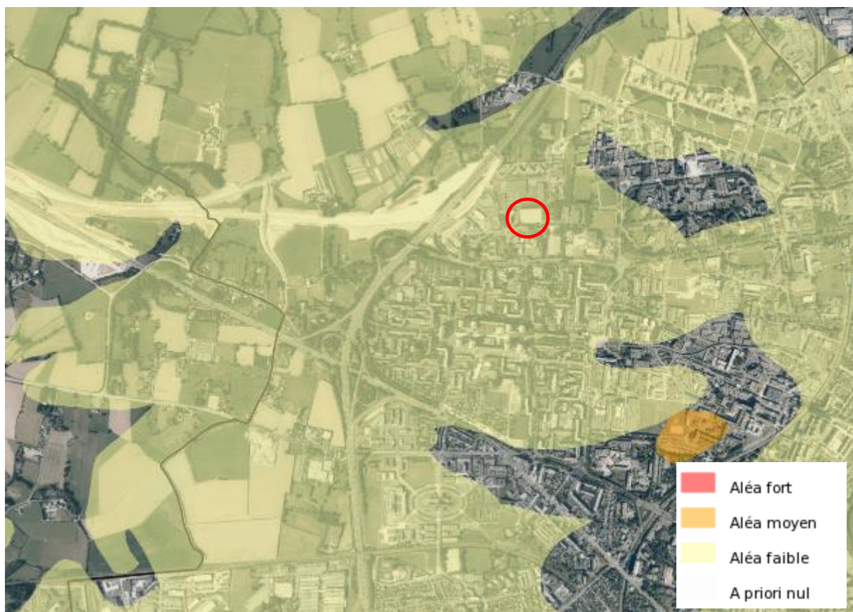
Figure 7 : positionnement du projet de déchèterie par rapport aux zones de retrait / gonflement des argiles (source : Géorisques – BRGM)
